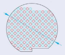
Imagen 5. Plano transversal del electroclorador 3D, en el que se aprecian las varillas que lo conforman y que alternan ánodos y cátodos.
