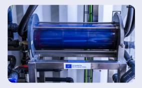
Imagen 4. Electroclorador 3D diseñado para la segunda etapa del proyecto LIFE Conquer.
